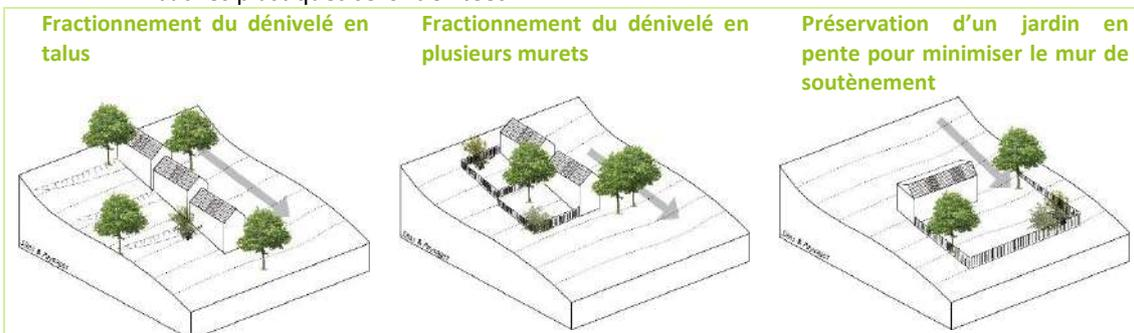
Image 13 - Illustration de minimisation des terrassements dans les terrains en pente
